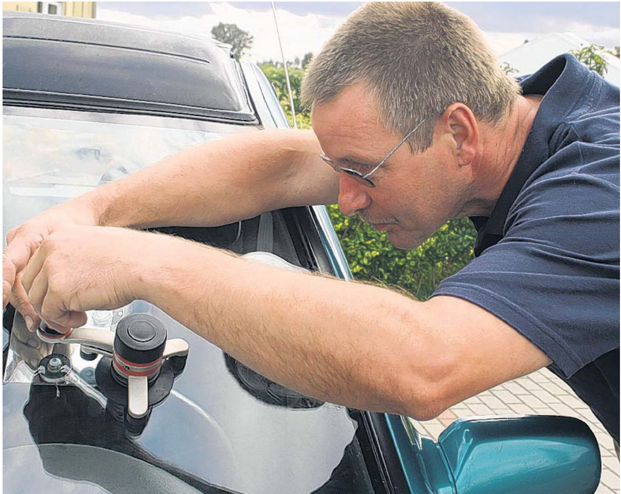
Hardy Krohn bei der Reparatur eines Steinschlag-Schadens
